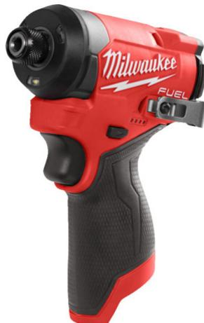
Moteur Brushless sans charbon Vitesse de rotation jusqu'à 3600 tr/min Les Tri-LEDs fournissent un éclairage haute définition pour augmenter la visibilité de l'espace de travail La commande 4-Mode DRIVE CONTROL permet à l'utilisateur de passer à trois réglages différents de vitesse et de couple ainsi qu'à un mode auto taraudeur pour maximiser la polyvalence des applications Mandrin hexagonal 1/4" pour un changement rapide et facile des mèches Sans batterie, ni chargeur.
