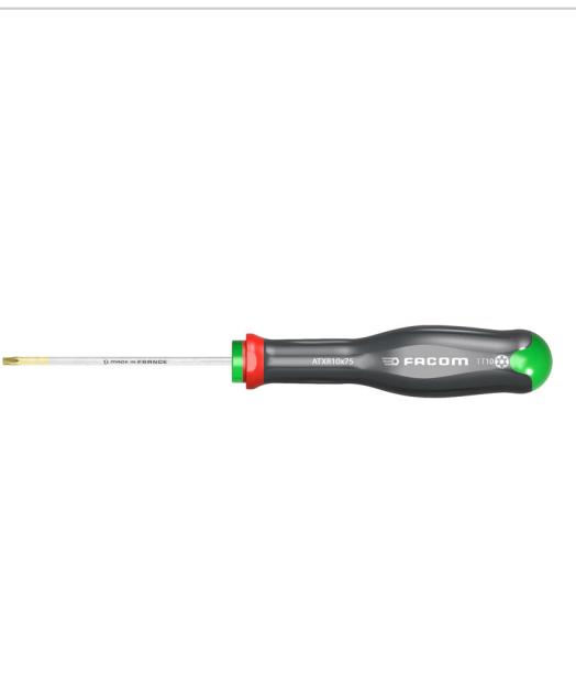
Conforme aux spécifications Resistox®. traitement thermique en ligne manche soft traitement « tri-coating » de la lame (Zinc-Nickel-Chrome) ergonomie optimisée du manche marquage laser usinage des empreintes par commande numérique.
