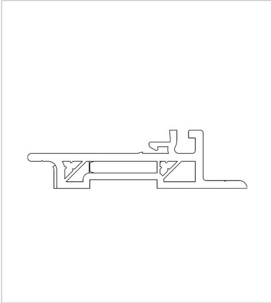
Profil PVC avec ailette réceptionnant le profil alu de protection de passage pour constituer le seuil REHAU sous avis technique N°6/11-2003\_V1.
