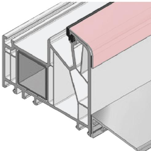
Profil de protection de passage en aluminium pour dormants PVC.
