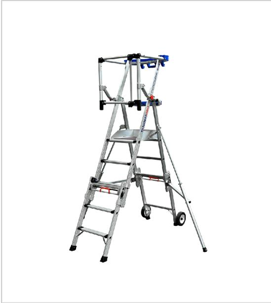
3 ou 4 hauteurs pour un seul produit, réglage facile de la hauteur par plans coulissants actionnés par une commande manuelle. Verrouillage automatique garde-corps articulé, accrochage automatique 2 tablettes de série plancher antidérapant 0,50 x 0,40 m installation en dénivelés intégrée
