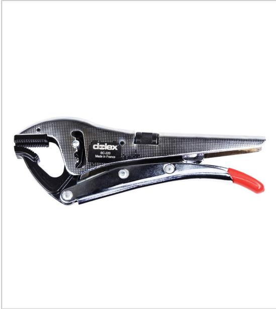
Crémaillère à 4 positions pour le réglage de l'ouverture (sauf le modèle BXL276 à 6 positions) carters estampés chromés mors en acier forgé, trempés et protégés par cathodose avec denture 58/60 HRC largeur des mors : 16 mm disponible jusqu'à épuisement.
