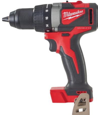
Moteur Brushless sans charbon protection REDLINK contre les surcharges, les surchauffes et les décharges totales mandrin métal 13 mm indicateur de charge et éclairage LED vitesse à vide : 0-550/0-1800 tr/min livrée en coffret HD Box sans batterie, ni chargeur.
