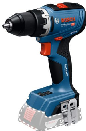
Moteur Brushless sans charbon Mandrin métallique 13 mm Fonction KickBack Control désactivable Double éclairage LED Régime à vide : 0-550/0-2100 tr/min Livrée en coffret L-BOXX Sans batterie, ni chargeur.
