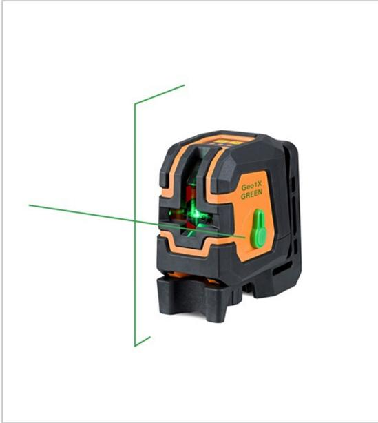
1 croix laser précision : 'b1 3 mm / 10 m diode : verte portée sans cellule : 15 m ouverture d'angle Hz/VI : 110°/120° alimentation : 4x AA Alkaline /12 h indice de protection : IP 54 alarme visuelle et sonore quand le laser n'est pas de niveau support mural trou pour fixation par vis ou aimants sur le dos du support filetages 1/4" & 5/8" pour utilisation sur trépieds livré avec support mural, 4 x AA piles alcaline, sacoche de transport et carton quadri avec trou de fixation.
