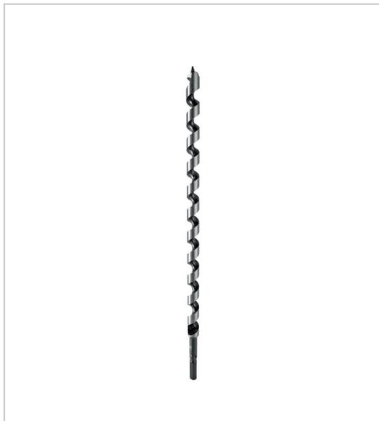
Permet le perçage de trous profonds dans les poutres et les chevrons. Egalement utilisée par l'industrie navale, pour le perçage des traverses de chemin de fer. Queue hexagonale traçoir pour coupe net et sans bavure, auto-perçante système modulaire permettant d'adapter un fraiseur à fond plat pour noyer la tête de boulon en une seule opération.
