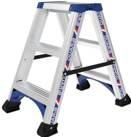
Marchepied double accès marches antidérapantes de 80 mm soudées sur de larges profils aluminium patins extra larges antidérapants articulations anti-pince-doigts charge utile 150 Kg compas anti-écartement : sur les modèles 2 x 5 deux sangles de sécurité anti-écartement : sur les modèles 2 x 3 et 2 x 4 marches.
