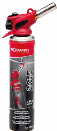
Domaines d'applications : sanitaire, soudage étain, brasage, dégrippage, brûlage type de flamme : dard composé d'une tête de lampe à cartouche et d'une cartouche butane-propane-propène ref.2015 fonctions : réglage de la flamme par volant, allumage piézo, retournement possible au bout de 10s maxi (15s à la 1ère utilisation d'une cartouche), pied tournant puissance : 2kw autonomie : 1h20 capacité de brasage sur raccord droit selon les gaz : - avec brasure CuPh : Ø18 - avec brasure 6% Ag : Ø20.
