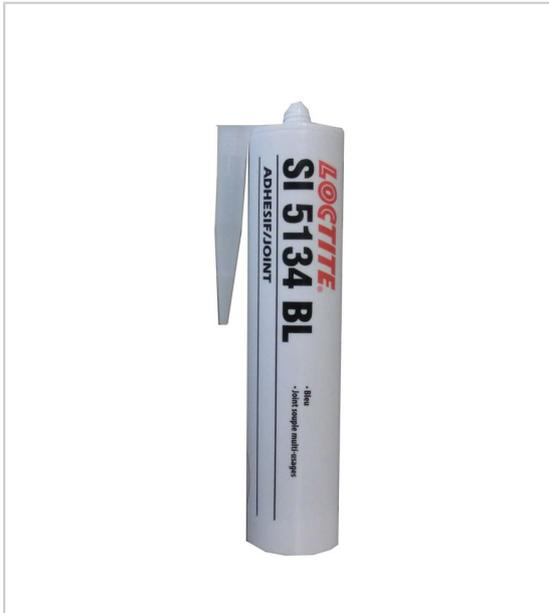
Élastomère de silicone monocomposant polymérisant à température ambiante étudié pour être utilisé comme joint d'étanchéité applications dans le domaine du joint automobile ou de l'industrie remplace par exemple les joints découpés sur carters, collecteurs, portes de visite résistance aux huiles.
