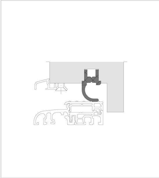
Joint d'étanchéité bas de porte pour rainure à ferrage 16mm.
