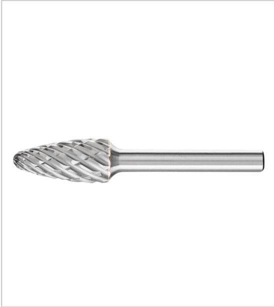
Applications : acier, acier moulé, acier trempé, de cémentation, acier d'une dureté supérieure à 1200 N/mm<sup>2</sup> pour fraisage, égalisation, ébavurage, usinage des surfaces et des cordons de soudure fraise sur tige en forme d'ogive à bout arrondi selon DIN 8032 diminution des vibrations et du bruit.
