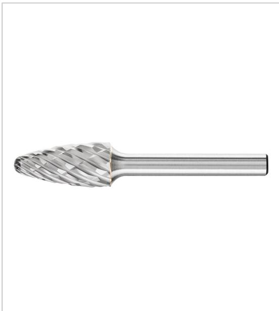
Applications : fonte, fonte gube, fonte malliable à coeur noir ou blanc pour fraisage, égalisation, ébavurage, usinage des surfaces et des cordons de soudure fraise sur tige en forme d'ogive à bout arrondi selon DIN 8032 diminution des vibrations et du bruit.
