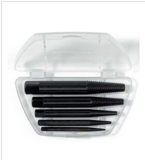
Pour l'extraction sans dommage de vis ou boulons filetés cassés hors des alésages filetés : pré percer la vis à retirer avec l'aléseeur adapté, rentrer l'extracteur dans l'alésage jusqu'à ce que la vis se desserre et puisse être extraite ne convient qu'à un filetage à droite composé d'extracteurs pour vis M3 - M6, M6 - M8, M8 - M11, M11 - M14 et M14 - M18. dimensions : 1 - 2 - 3 - 4 - 5 mm.
