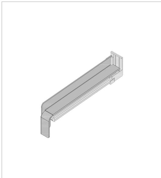
Retirer 2mm par embout sur la cote utile de la tablette.
