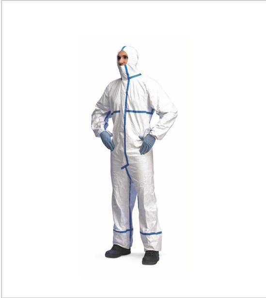
Combinaison à usage unique utilisée pour la manipulation de produits chimiques, solides, liquide et aérosols et en protection contre les risques biologiques combinaison en Tyvek® avec capuche élastiquée en 2 pièces, élastiques entunnelés aux visage, poignets, chevilles, fermeture à glissière sous rabat adhésif sur menton. Coutures recouvertes traitement antistatique sur les 2 faces.
