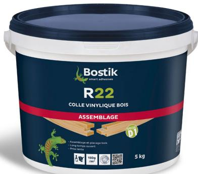
Colle vinylique pour assemblage et placage de bois à prise lente colle en émulsion, prête à l'emploi, à temps ouvert long, ininflammable, ne tache pas non toxique temps ouvert maximum à +20°C : 30 minutes température d'utilisation : +8°C minimum résistance finale du collage obtenue après 7 jours environ.
