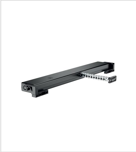
Boîtier à chaîne LIWIN 35 SLIM IQ SYNCHRO pour ouvrant largeur maximum : 3000 mm avec 2 appareils (maxi 8 BAC, espacement de 1500mm par boîtier à chaîne).
