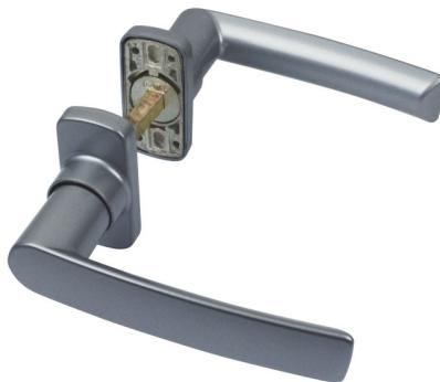
Béquille de porte en aluminium moulé sous pression avec ressort de rappel et rosace cache-vis à maintien de position par ressort.
