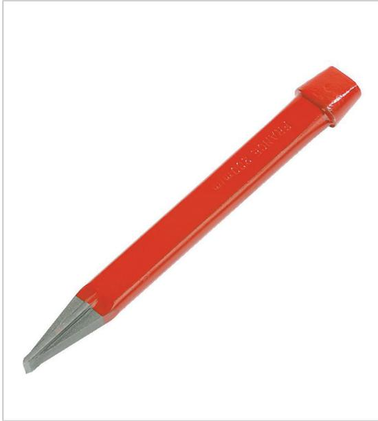
Tête de sécurité brevetée : pas de risque d'éclat et champignonnage réduit acier allié au Silicium d'excellente tenue mécanique 51SC7 réaffûtabilité à c'9cur à vietaillant agressif et résistant dureté de la zone travaillante 52-58 HRC peinture époxy zone de préhension à chant plat.
