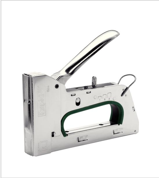
Puissante force de frappe de réglable système anti-recul chargement par l'arrière bloc-poignée pour le rangement chargeur de 84 agrafes pour agrafes n°140 de longueur 6-14 mm application : pose de matériaux d'isolation, lambris PVC, moquettes poids : 890 gr.
