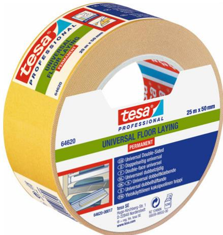
Adhésif double face composé d'un support blanc PP et d'une masse adhésive en caoutchouc synthétique sans solvant et tack élevé équipé d'un protecteur papier siliconé épaisseur totale : 185 µm pouvoir adhésif sur PE : 5 N/cm allongement à la rupture : 700 % résistance à la rupture : 30 N/cm coloris : blanc longueur : 25 m largeur : 50 mm.
