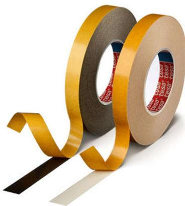
Ruban adhésif en mousse PE double face pour les applications de fixation compose d'un support en mousse PE et d'une masse adhésive acrylique tackifiée convient pour l'extérieur : résistant aux UV, à l'eau et au vieillissement. Applications de fixation générales, fixation de moulures et de profilés, cadres de panneaux solaires. épaisseur totale : 1000 µm.
